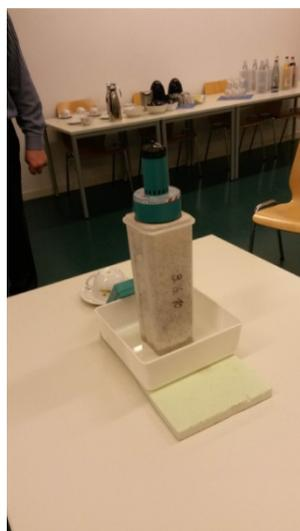
Unterschiedlich dicke Zement-Estrichproben befinden sich in einer PVC-Form, die unten und oben offen ist. Zum Messfeld-Eindringversuch wurde eine PVC-Wanne verwendet, die ihrerseits auf einer 2-cm-dicken Styroporplatte lag, um das Geräte-Messfeld nicht durch Streufelder zu verändern.
